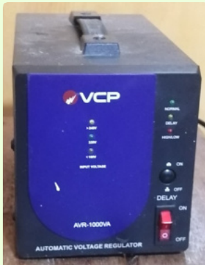
電圧安定器:写真は1KVAタイプのもですが、2KVAタイプのものも使用しています。
